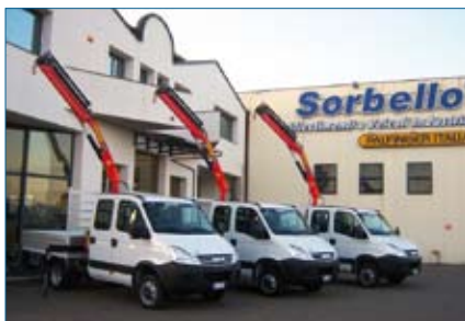
Veicoli da 35 q dotati di cassone fisso e gru Palfinger PK 3207
