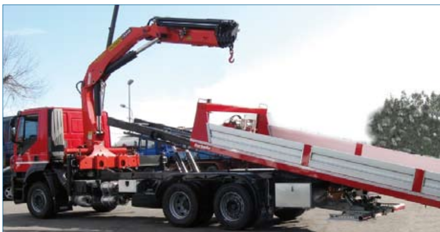
SE.MI.DA srl ha commissionato a Sorbello Tre la gru retrocabina Palfinger PK 23500 collaudata anche per uso cestello e un pianale scarrabile per soccorso stradale
